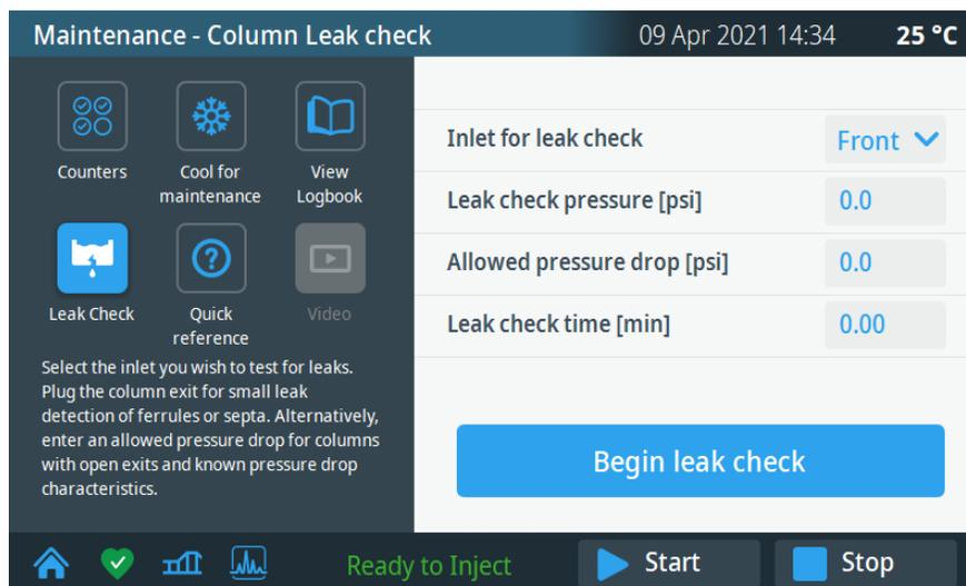
在泄漏检测页面中，可选择进样口的前/后，设置泄漏检测的压力和时长，设置允许的压降。要启动此程序，请按 **Begin leak check**（开始泄漏检测）。
