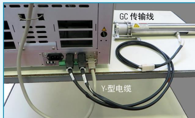
利用 GC 传输线的线电压为两个加热区供电。每个区都有两个筒式加热器和一个电阻式温度检测器 (RTD)，安装在包有不锈钢传输线的铝制热分配器内。
