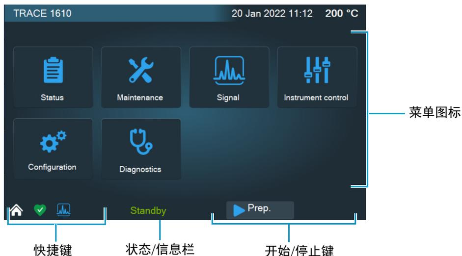
每个仪器功能都有对应图标，点击即可打开对应菜单，图标功能如下：状态、维护、信号、仪器控制、配置和诊断。
